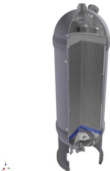
Figur 9. Illustration av reaktor för framställning av e-metanol ur vätgas och koldioxid. Illustration: Haldor Topsoe.
